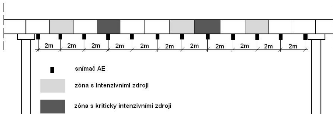
Obr. 7: Schéma vyhodnocení stavu nosníku z hlediska koroze
